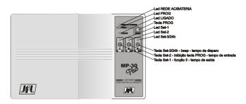
**LED REDE AC/BATERIA** - Quando aceso indica que o aparelho está sendo alimentado pela rede elétrica 110 ou 220 volts e quando piscando indica que o aparelho está sendo alimentado pela bateria, nesse caso a central emite um beep.
