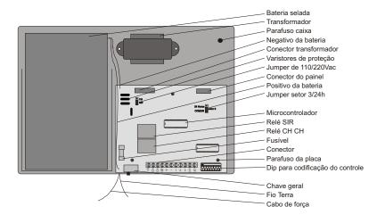
**BATERIA SELADA:** Bateria de 7 A/H usada para alimentar o aparelho na falta de energia elétrica.
