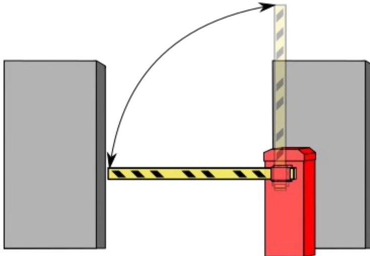
2º Providencie um ponto de energia interrompido por um disjuntor de 10A próximo de onde a cancela será instalada.
