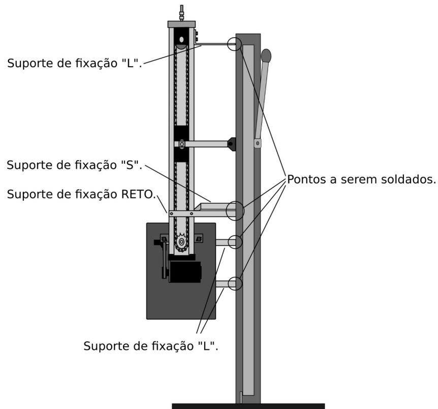
5° Com o Movimentador fixado ao portão realize a verificação da Corrente. Para realizar o ajuste aperte a porca do esticador (5/16 polegadas) como mostra a imagem abaixo. Mantenha sempre a corrente esticada conforme o padrão do fabricante: De 15 mm à 25 mm de folga.
