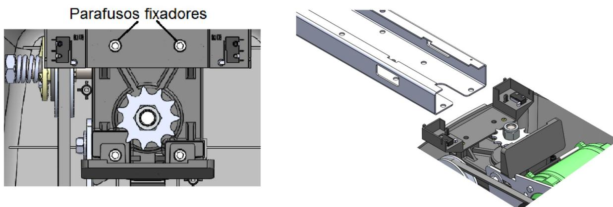
3º Após a calha de encaixe estar na posição correta, coloque os parafusos fixadores.
