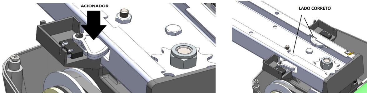
6º Após a fixação dos acionadores, remova o esticador para colocar a corrente (o ajuste será executado posteriormente).
