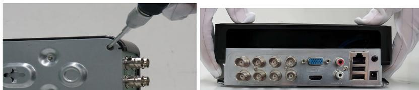
2. Posicione o HD devidamente aos seus pontos de fixação no case do DVR e utilize os parafusos fornecidos para sua fixação.
