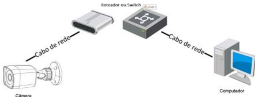
Figura 3.1 – Conexão via Rede LAN
