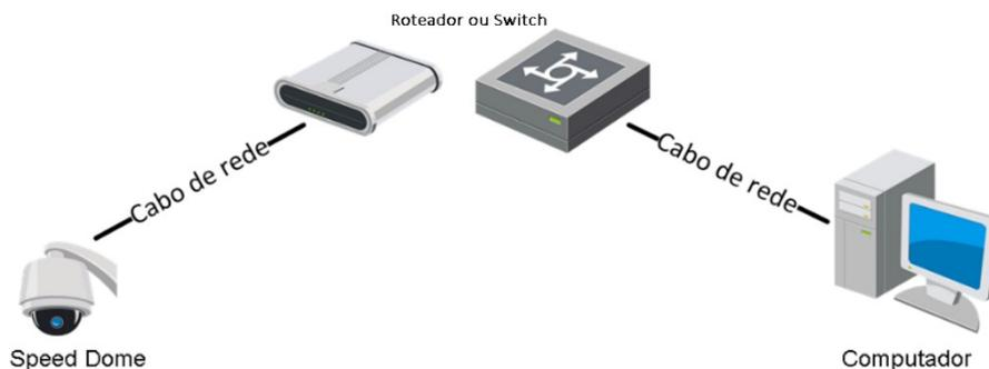
Figura 2.1: Conexão via rede LAN
