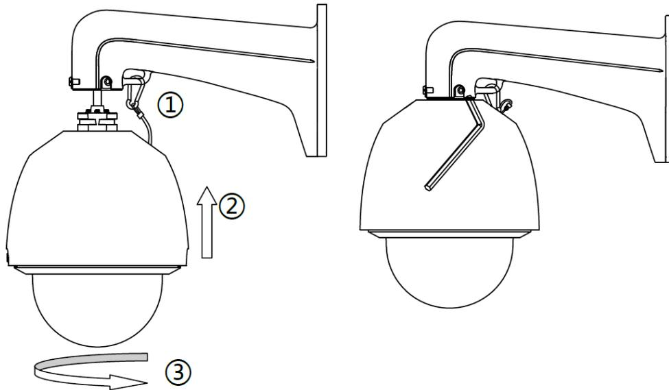
Figura 4: Instalando a Speed Dome
