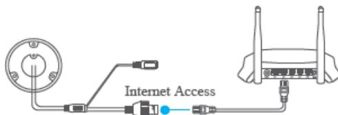
Figura 4.2: Conecte a um roteador
