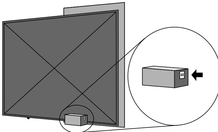
4º Posicione o movimentador com o lado da engrenagem virado para a folha do portão, conforme imagem abaixo. Marque os quatro furos da base do movimentador e faça os furos de acordo com a medida dos parafusos que acompanham o kit de instalação. Com as furações feitas, coloque as quatro buchas que acompanham o kit, posicione o movimentador e aperte os parafusos.
