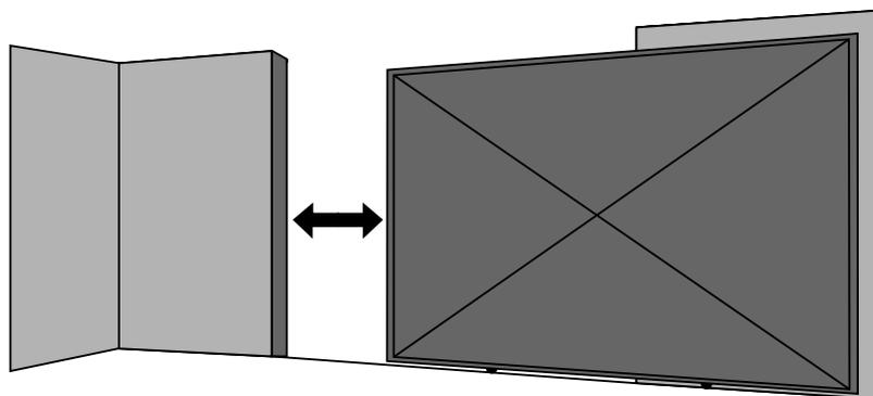
2º Para a instalação do movimentador deslizante é necessário uma base de concreto ou uma base metálica para a fixação do mesmo. A base deve ter uma medida mínima conforme mostra a imagem. É importante que a base fique com sua superfície na mesma altura dos trilhos e aproximadamente 25 mm de distância da folha do portão.
