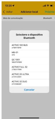
5. Termine o cadastro do local com nome e a senha para conectar na central. Clique em conectar. O aplicativo programador conectará na central de alarme e irá baixar toda programação. Durante a conexão Bluetooth o LED Status fica na cor ciano ●.
