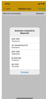
5. Termine o cadastro do local com nome e a senha para conectar no módulo. Clique em conectar. O programador vai conectar no módulo e baixar a programação. Durante a conexão Bluetooth o LED Status fica na cor ciano.
