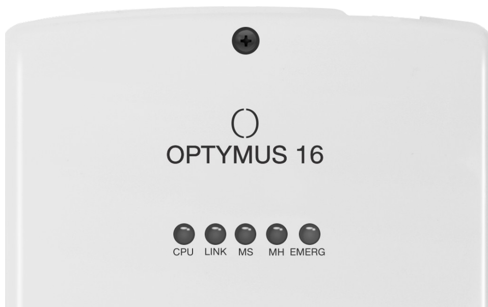
Figura 15: LEDs da Optymus 16
