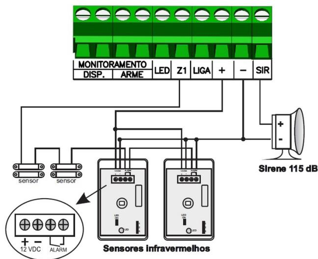
O eletrificador tem uma saída para ligação de uma sirene piezoelétrica com capacidade de 200 mA. Esta sirene aciona quando for cortado ou aterrado os fios da cerca, com a violação dos sensores com fio instalados na entrada (Z1) e com sensores sem fio Hopping Code JFL na frequência de 433,92 MHz.
