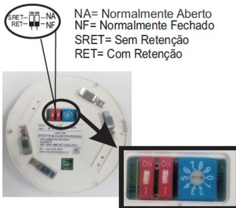
Figura 2 : Configuração do modo normalmente aberto, normalmente fechado, com retenção e sem retenção.
