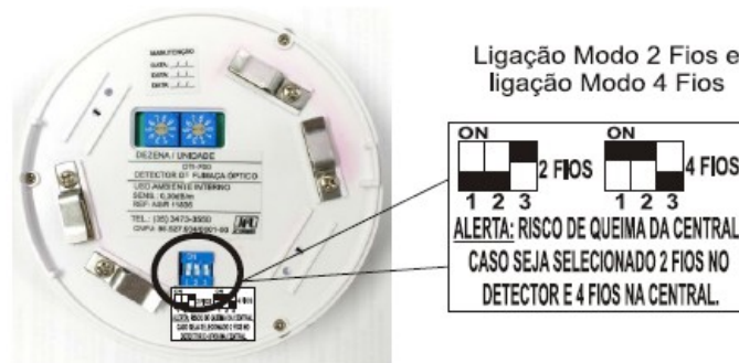
Figura 3 - Configuração do modo 2 ou 4 fios
